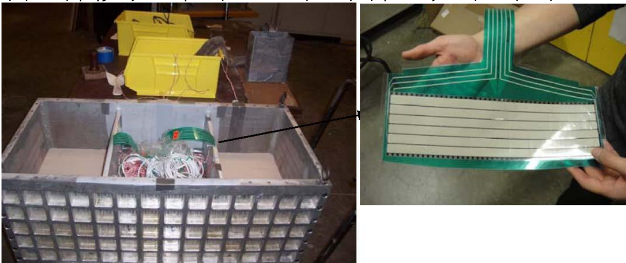
Σχήμα 5: Προετοιμασία μοντέλου. (α) Το υλικό επίχωσης τοποθετείται πίσω από τους τοίχους. (β) Οι επαφές των αισθητήρων πίεσης αφής έχουν ήδη τοποθετηθεί στους τοίχους.
