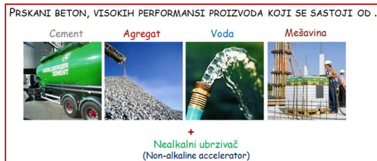
Sl.94:- Šematski prikaz sastava prskanog (mlaznog) betona
