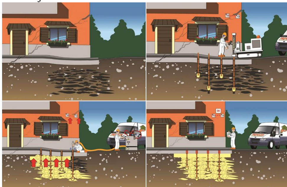
Sl.39:- Ojačanje tla ispod postojećih temelja objekta i faze injektiranja.
