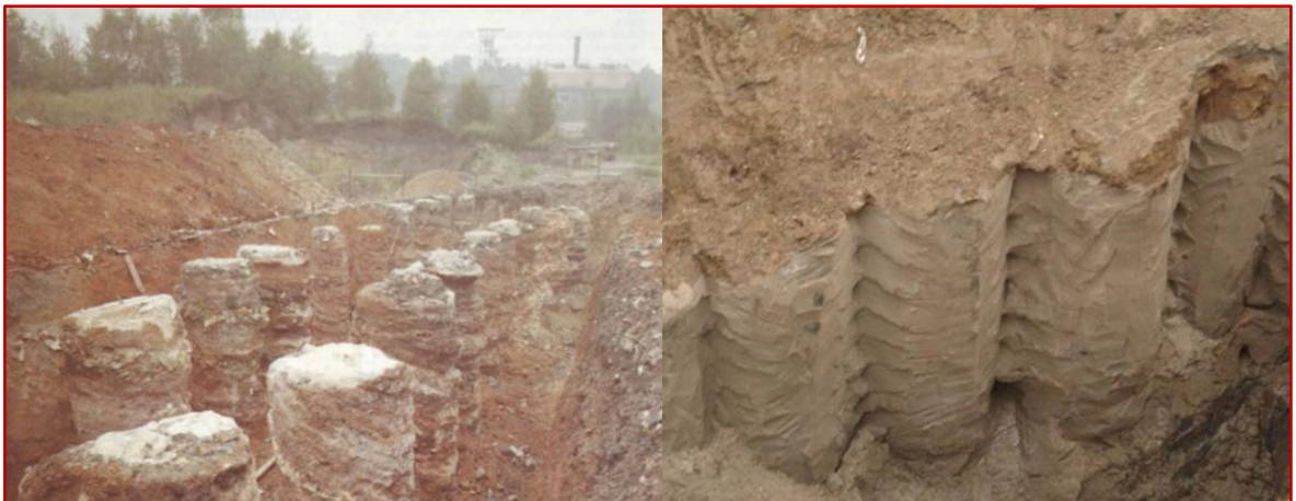
Sl.65:-Izgled mlazno injektiranih tela - stubova (iskopana opitna deonica)
