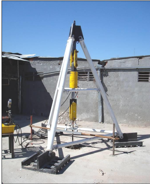
Figura N° 43: Marco de carga de 100 tn para ejecutar ensayos de carga a tracción de micropilotes
