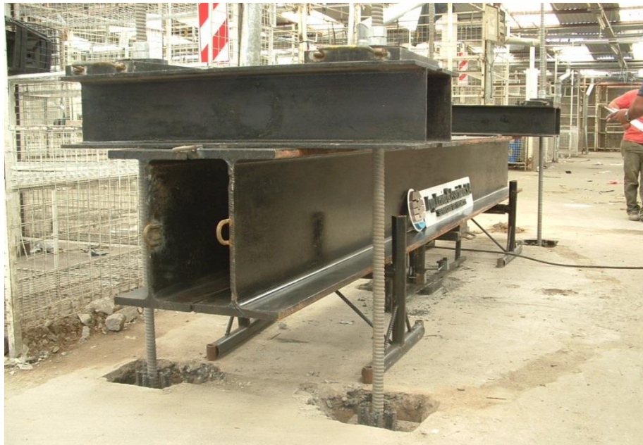
Figura N° 49: Ensayo de carga a compresión de un micropilote
