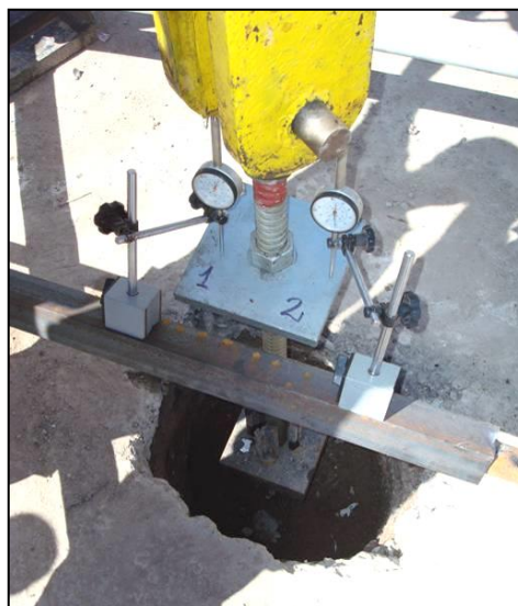
Figura N° 44: Esquema de medición de las deformaciones en ensayos de carga
