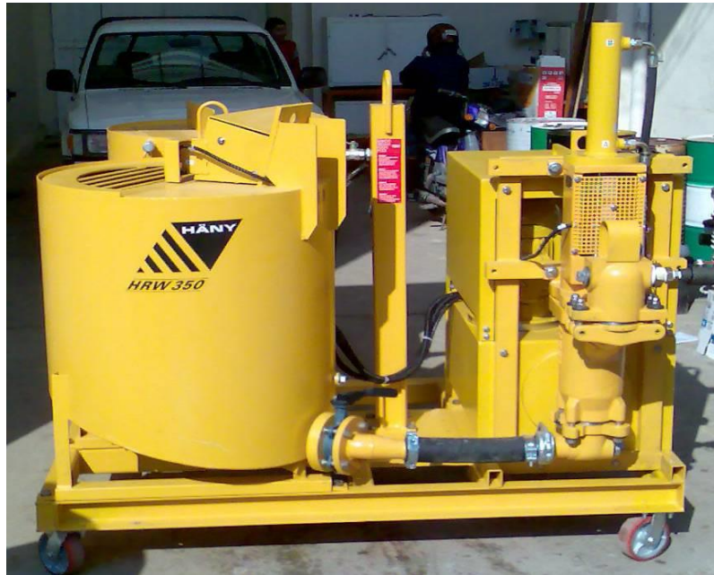
Figura N° 20: Equipo compacto para confeccionar las lechadas e inyectarlas a presión
