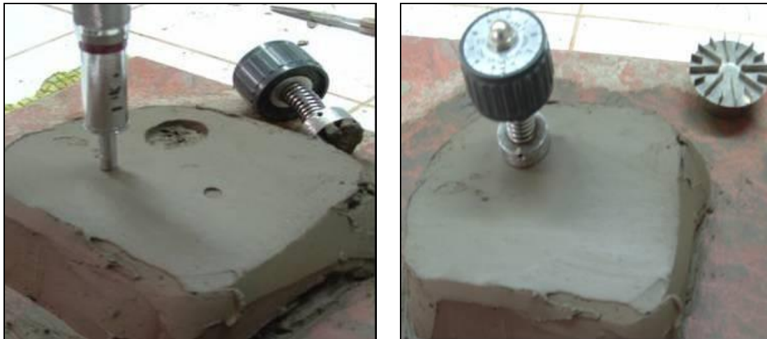
Figura Nº 7.13: Determinación de la resistencia al corte de arcillas amasadas en el laboratorio
