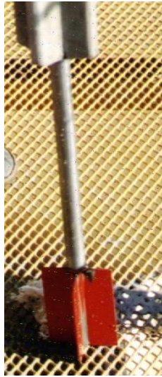
Figura N° 7.57: Velea de corte de 113 mm x 65 mm del equipo GEONOR H-10
