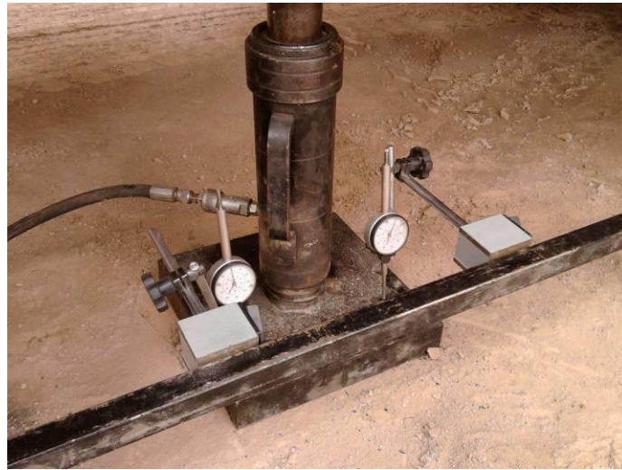
Figura N° 7.36: Fotografía del montaje de un ensayo de plato de carga
