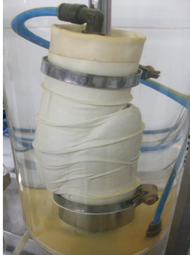
Figura N° 7.18: Ensayo triaxial cíclico sobre una probeta de arena
