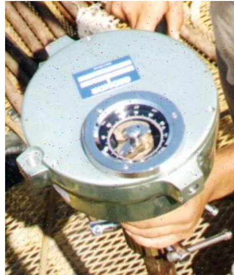
Figura N° 7.58: Molinete para la aplicación del momento torsor a la veleta
